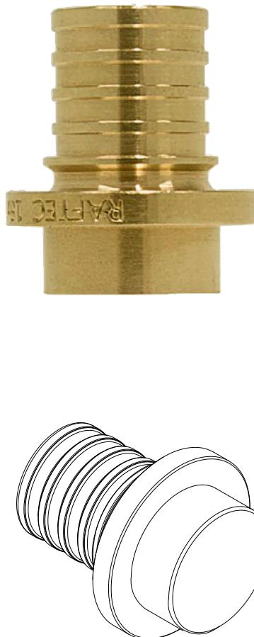
**Заглушка натяжна** - латунний фітинг призначений для створення з'єднань в системах труб зшитого поліетилену PEX-A. Використовується в системах питного, господарського, технологічного, холодного і гарячого водопостачання, опалення, стисненого повітря.
