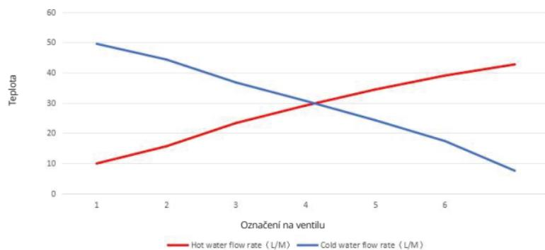
Nastavení teploty třícestného ventilu
