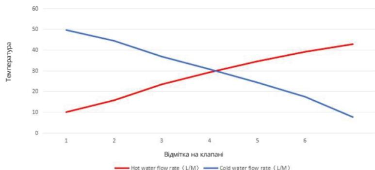
Налаштування температури триходового клапана
